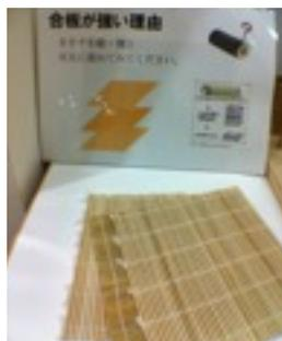
まきすのような一方に編み上げたものは、材木を桂剥きにした1枚の木皮に似ています。1枚では弱い木皮であっても繊維方向を互い違いにして3枚重ねれば信じられないくらいの力を発揮します。巻きすで試してみてください。
