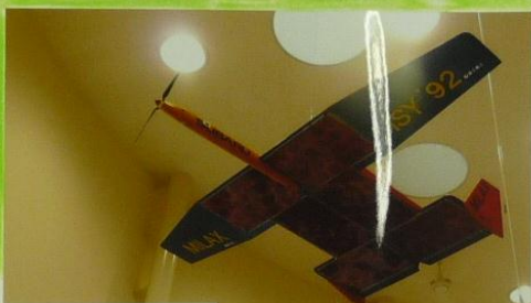
← マイクロ波による電力伝送でプロペラ飛行機
